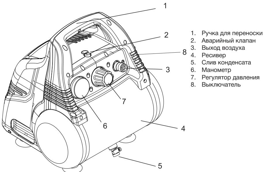
Воздушный компрессор представляет собой устройство для сжатия и подачи воздуха под давлением и используется в качестве энергоносителя при строительных работах, автослесарных работах, в приводах систем автоматики, пневматических машин и другого пневмооборудования.
