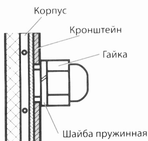
Рис. 3а. Крепление кронштейнов к корпусу
