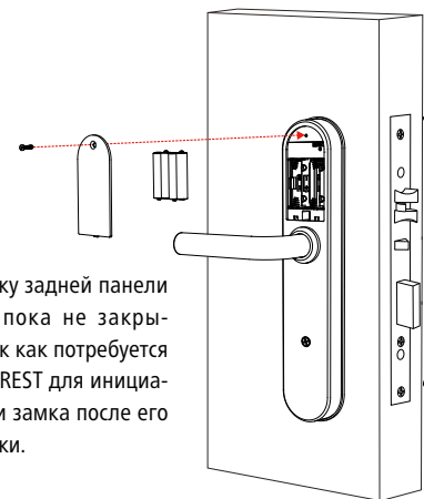
Установите источники питания и заднюю крышку
