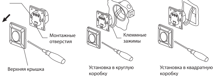
Рисунок 10. Схема монтажа датчика ДДМ-05В
