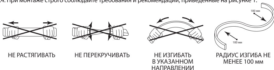
Рисунок 1. Требования и рекомендации для монтажа гибкого неона.
